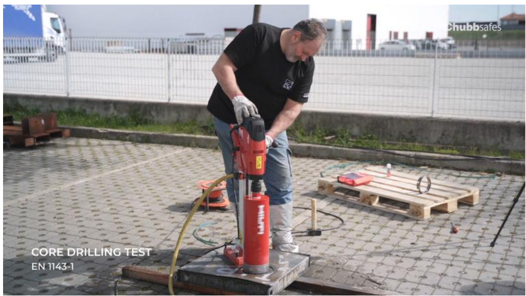
CORE DRILLING TEST EN 1143-1
